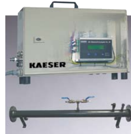
Рис. 2: Прибор для измерения потребления сжатого воздуха. Объемный поток определяется измерением разности давления в трубопроводе.
