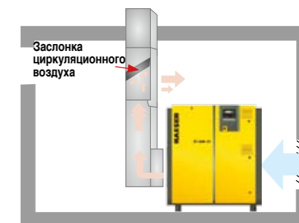
Рис. 4: Выравнивание температуры посредством жалюзи, управляемых термостатом
