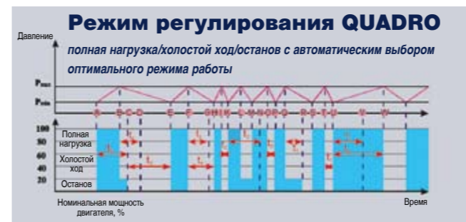
Внутренний блок управления компрессором «KAESER Sigma Control» оснащен четырьмя режимами управления
