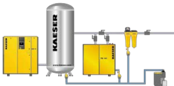
Подготовка сжатого воздуха (фильтр, подготовка конденсата к утилизации, адсорбционный осушитель, адсорбер на активированном угле)
