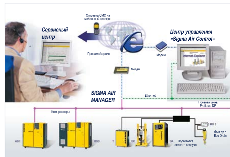
Profibus обеспечивает высокоскоростную передачу данных между компрессорной станцией и центральной системой управления
